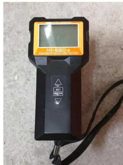
Figure 4 Kett HI-520-2 surface moisture meter
