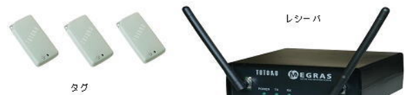
図-3 RFIDタグ、リーダの例
